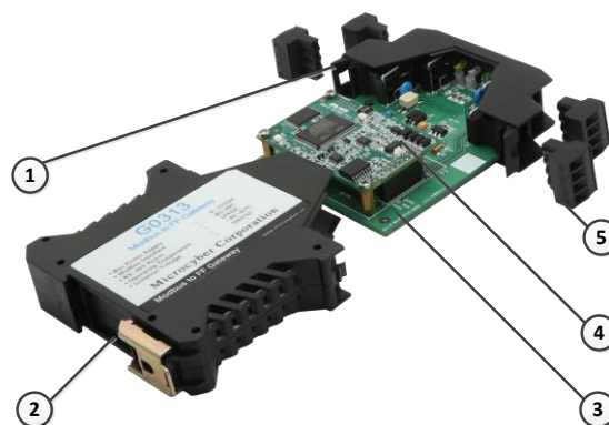
图 1.3 网关设备整机结构
